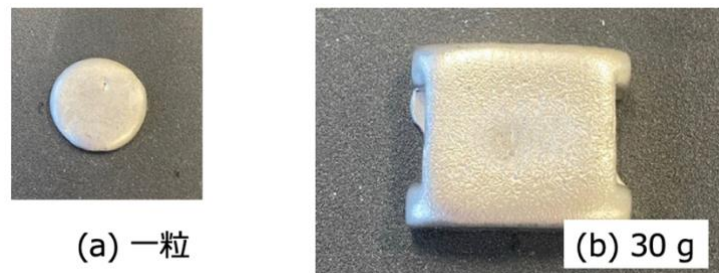
図2 注入装置を介して鋳型で作成したインゴット，(a) 一粒（2.0 g），(b) 30 g.
