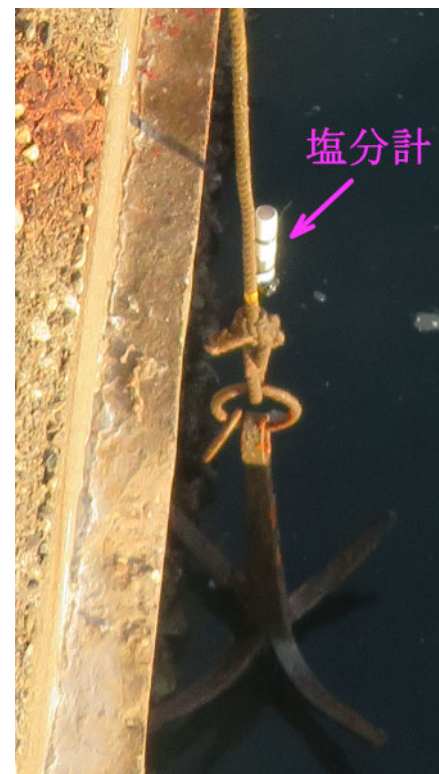
図6 観測ロープに取り付けた塩分計
