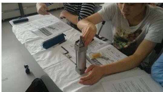
図 4. エアシリンダ一度分解し、組み立てなおして動作させる実習（SMC 様）
