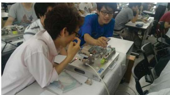
図 5. エアシリンダ実習キットを用いてシリンダの移動速度を調整する実習（SMC 様）
