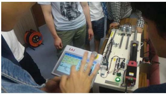
図 3. エアシリンダと電動シリンダの比較実験をしているところ（アイエイアイ様）
