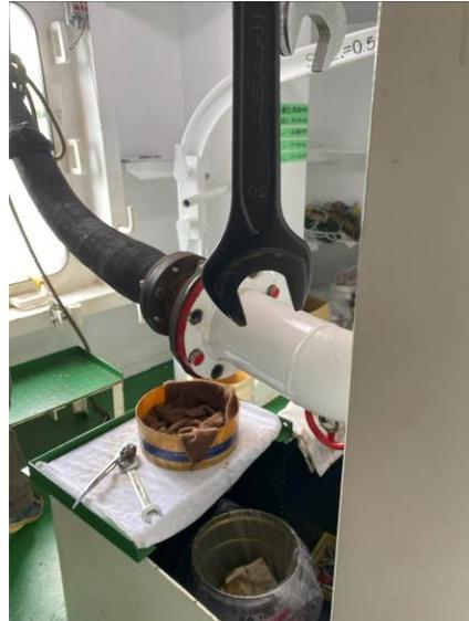
図7 バンカー船と本船の給油口の接続状況
