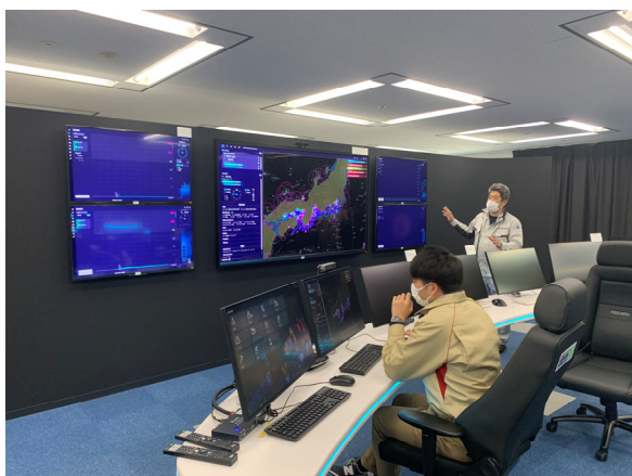
遠隔機関運航管理システム(遠隔機関機能)
