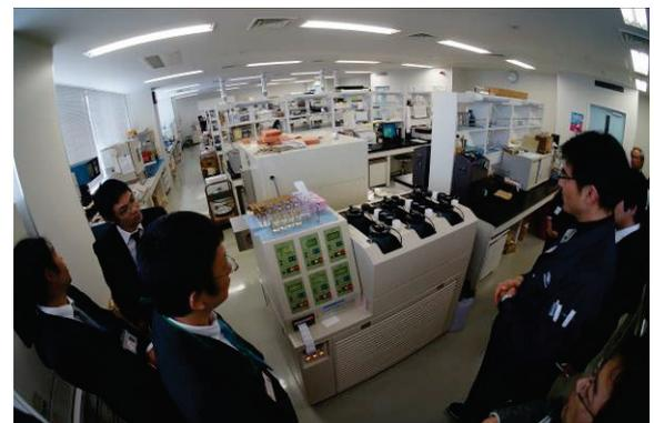
図6 自動流動点試験装置
