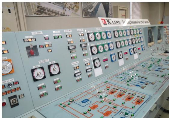
図2 LNG 船荷役機関シミュレーター
