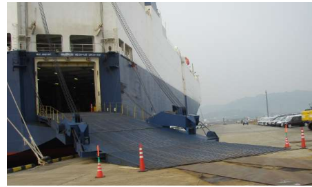
図2 油圧式ランプウェイ(船尾)
