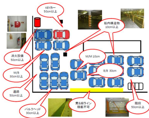
図 10 ホールド内での積み付け車両間隔
