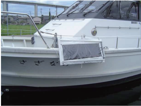
図4 ソーラーパネル設置(海面からの反射光発電)
